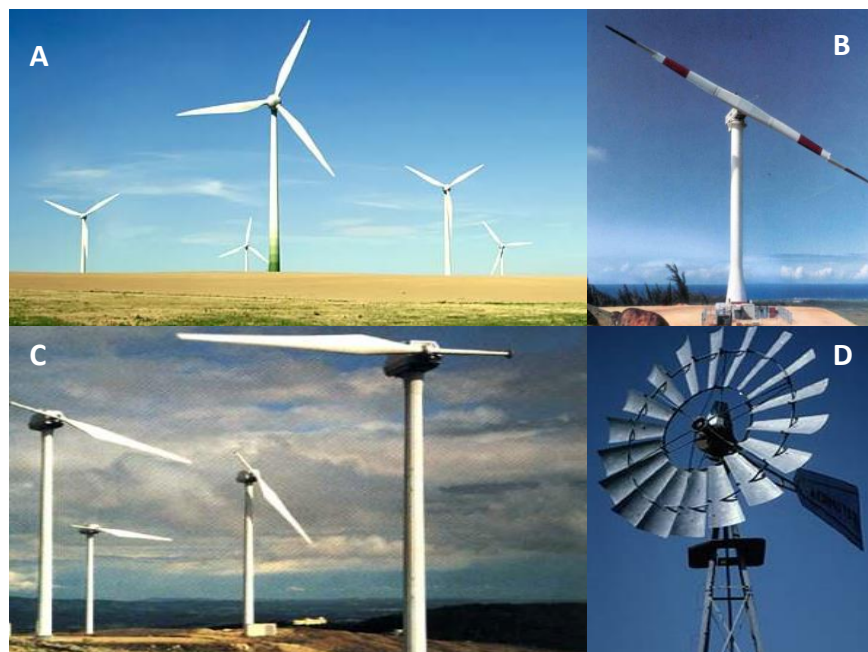
Figura 4.388 Aerogenerador de eje horizontal tripala (A), aerogenerador de eje horizontal bipala (B), aerogenerador de eje horizontal monopala (C) y aerogenerador de eje horizontal multipala (D).
