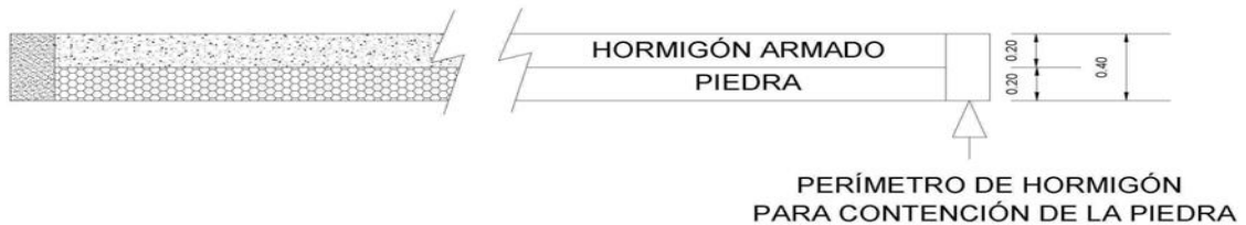
Figura 5.3 Losa de hormigón armado de 20 cm.
