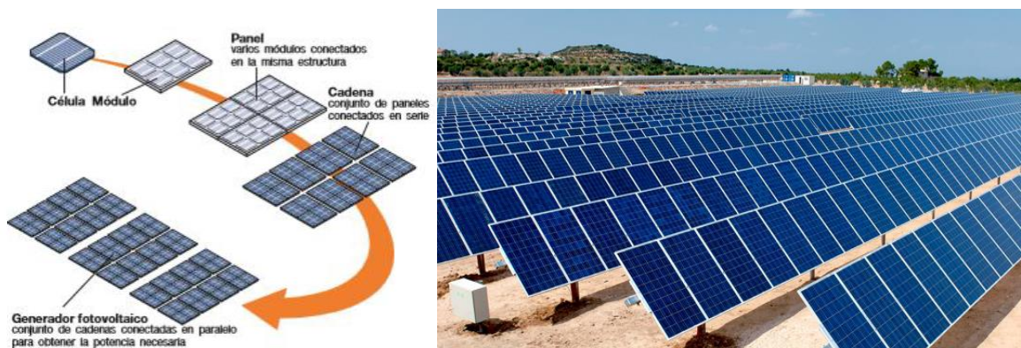
Figura 4.47 Placas conectadas en serie y huerto fotovoltaico.
