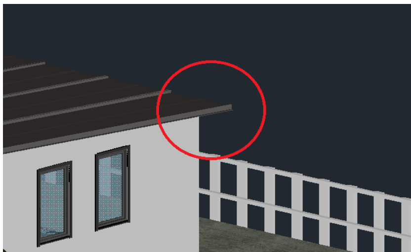
Figura 6.6 Voladizo del tejado para generar protecciones solares.
