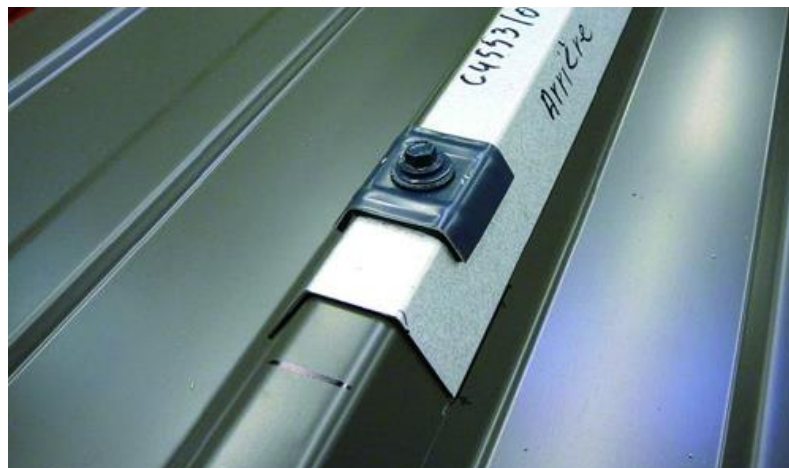
Figura 5.34 Detalle de la prueba mecánica del carril.
