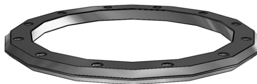
Figura 10.1 – Vista del anillo de carga (sin corona dentada)
