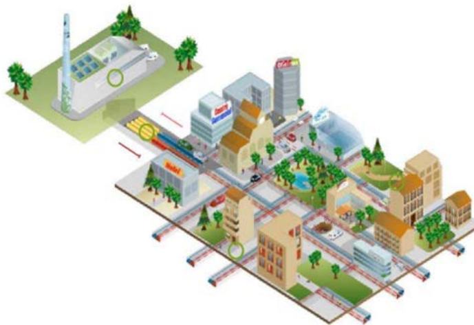
Ilustración 5.1 Esquema de la red de distrito en el que se muestran los elementos principales (central, red y consumidores). Fuente: IDEA
