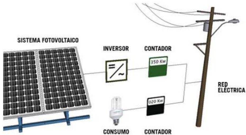
Ilustración 1.12. Esquema sistemas FV conectados a red. Fuente ix
