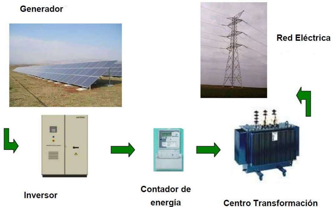
Figura 4.2.- Elementos de un parque fotovoltaico.
