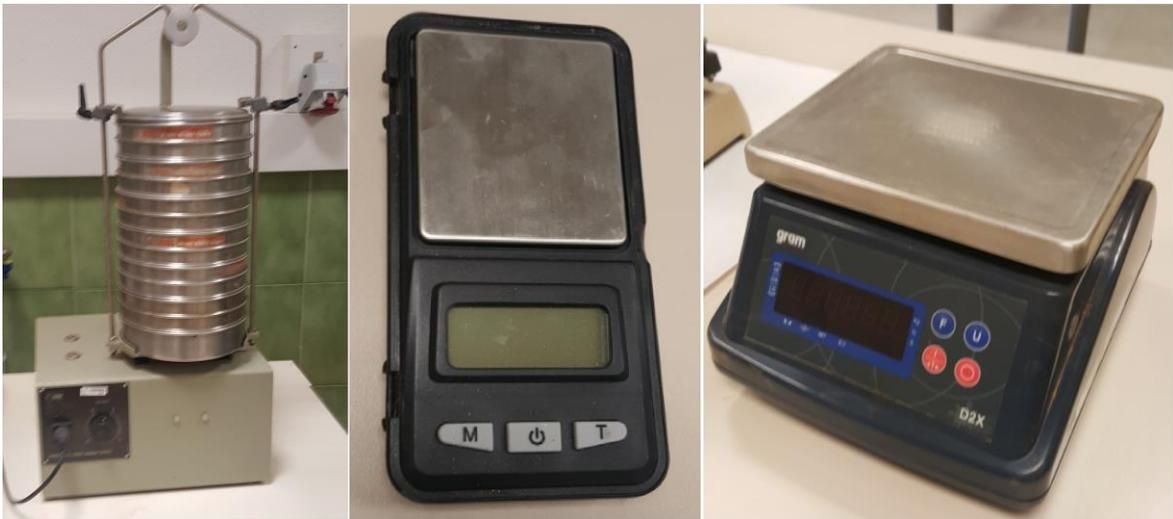
Ilustración 29. Equipos para realización de curva granulométrica.
