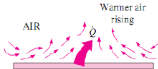
Figura 5.6.- Ejemplo de convección natural a través de una placa y aire.
