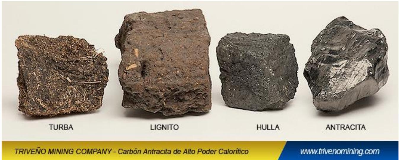
Figura 3. 1 Distintos tipos de carbón (CARBUNIÓN)
