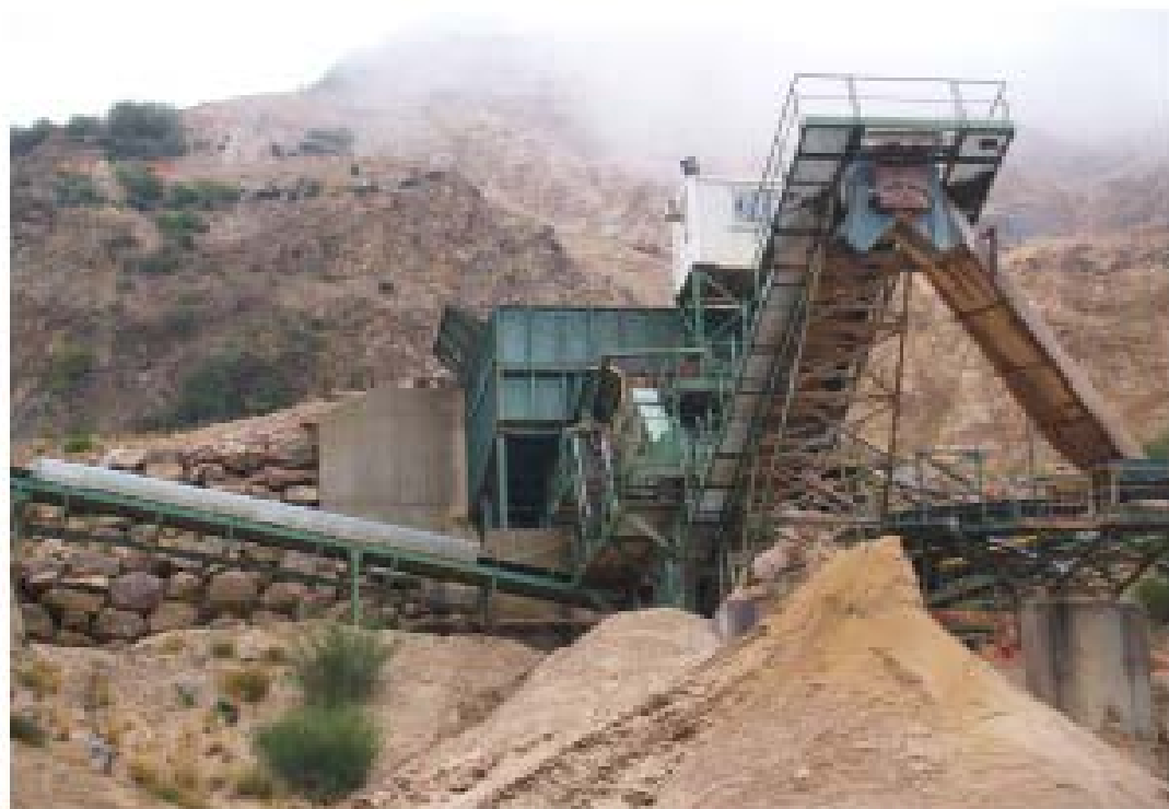
Foto 5.1.4.- Machacadora de mandíbulas ROHER P.135.100, con la cinta transportadora del producto del proceso primario. A la izquierda cinta de los finos separados en este proceso.
