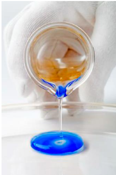
Figura 3.3.10 - Conmutación termocrómica de un tinte leuco durante la transición de líquido a sólido. Foto Fraunhofer (IAP).
