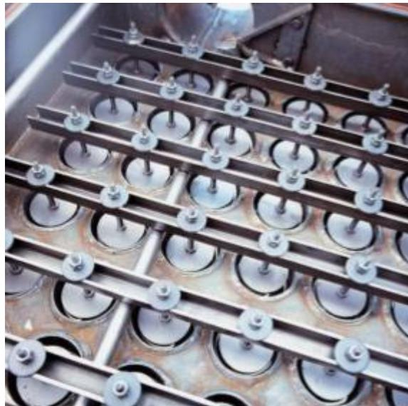
Figura 14.10.-Vista superior de un intercambiador vertical de calor con sistema de limpieza integrado en una caldera de biomasa [44]
