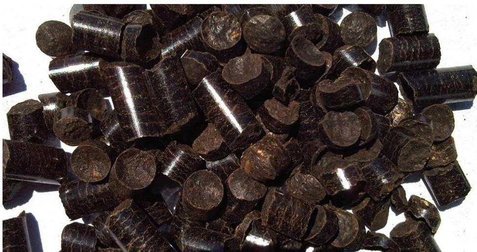
Figura 3.1.-Pellets de biomasa torrefactada
