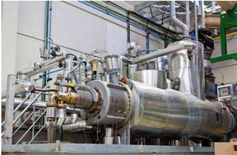
Figura 3.2.-Planta Piloto de Torrefacción del CENER
