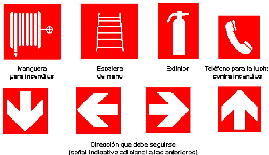
Figura 5.6 Señales de lucha contra incendios
