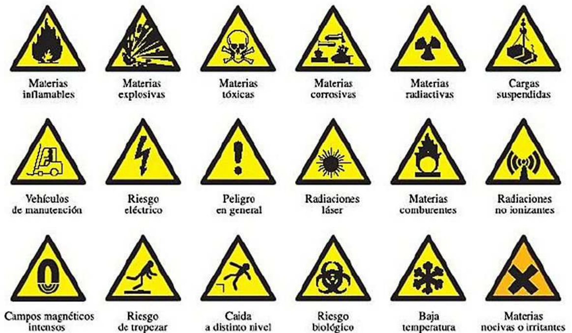
Figura 5.2 Señales de advertencia
