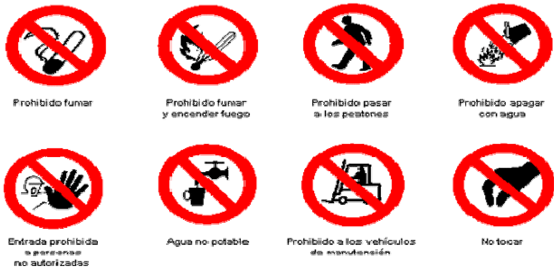
Figura 5.1 Señales de prohibición
