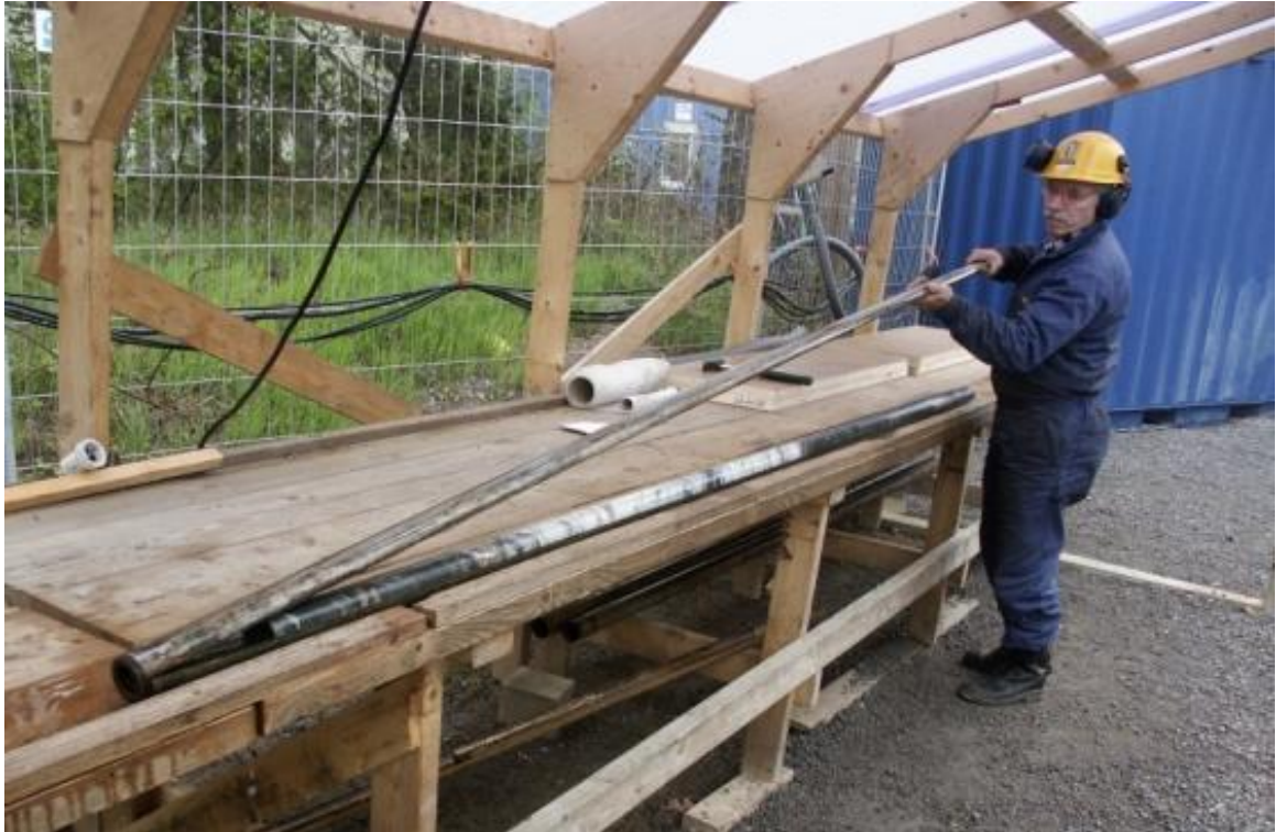
Figura 7.5.- Operación de extracción de testigo.
