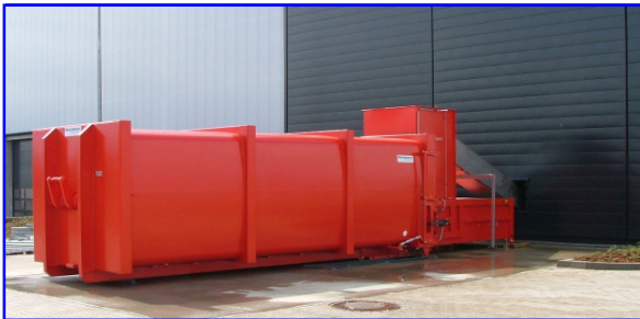
Compactador MP con cinta transportadora hasta la tolva
