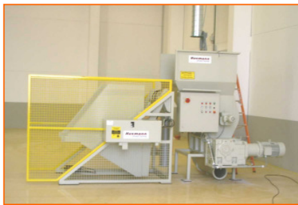
Trituradora HZ con dispositivo de empuje y volteador HKV
