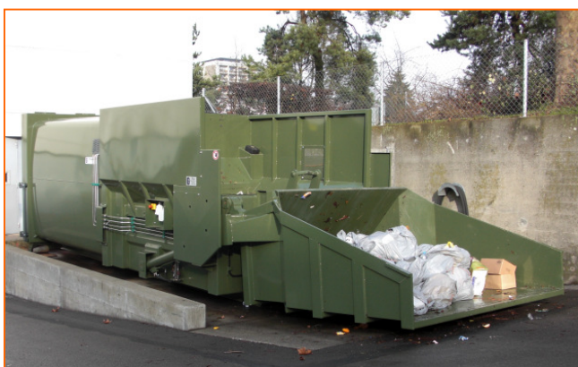
SPB con pala de carga – Llenado manual
