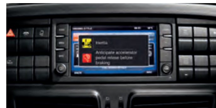
ADemás, MIENTRAS EL CAMIÓN SE DESPLAZA, APARECEN SUGERENCIAS PARA AHORRAR COMBUSTIBLE EN LA PANTALLA IVECONNECT (USO DE LAS MARCHAS, FRENOS, FRENADO CON EL MOTOR, ACELERACIÓN E INERCIA).
