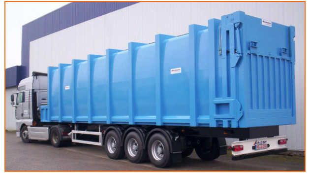
Contenedor de transferencia de 60 m³ con expulsión asistida
