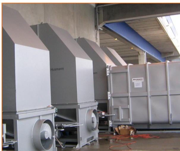
Compactador de tornillo con tolva directa a la pared
