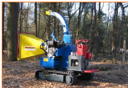
Astilladora con sistema de oruga
