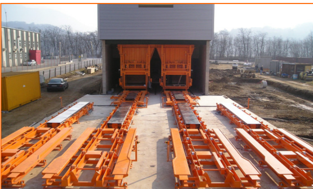
Compactadores MP 6000 en paralelo con sistema de cambio de contenedores
