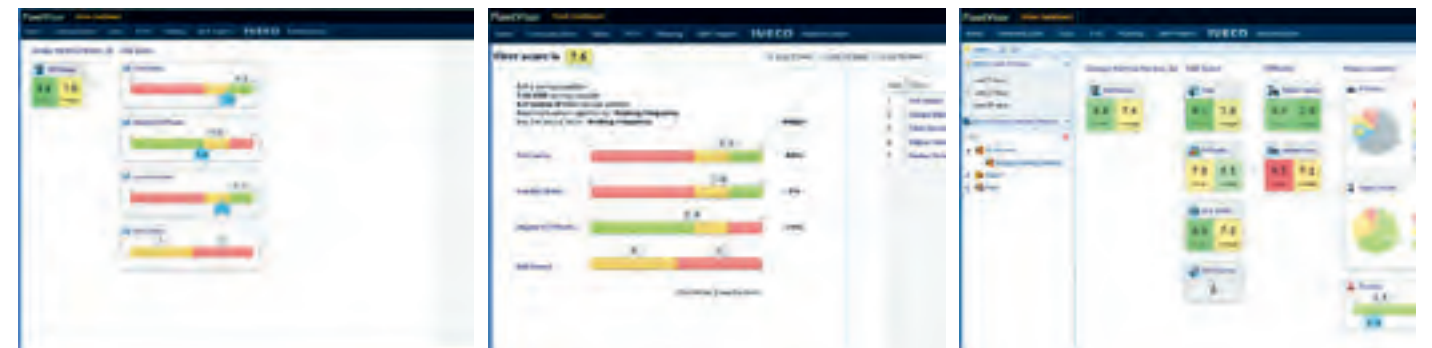
EL CENTRO DE OPERACIONES PUEDE MANTENER UNA COMPROBACIÓN EN TIEMPO REAL DE LOS TIEMPOS DE CONDUCCIÓN, EL CONSUMO, LA POSICIÓN POR GPS Y EL TIEMPO A DESTINO PREVISTO . EL SISTEMA TAMBIÉN PERMITE CUMPLIR AUTOMÁTICAMENTE OBLIGACIONES LEGALES RELATIVAS A LA DESCARGA, GESTIÓN Y ALMACENAMIENTO DE DATOS DE LOS TACÓGRAFOS Y TARJETAS DEL CONDUCTOR.
