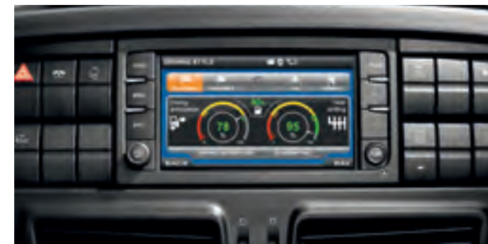
EVALUACIÓN DEL ESTILO DE CONDUCCIÓN: EL SISTEMA PROCESA LOS DATOS PROVENIENTES DEL MOTOR, EL CAMIÓN Y EL GPS UTILIZANDO UN ALGORITMO AVANZADO (DESARROLLADO POR IVECO) QUE EVALÚA EL AHORRO DE COMBUSTIBLE POR PARTE DEL CONDUCTOR. LA EVALUACIÓN ESTÁ BASADA EN UN JUEGO DE ÍNDICES EN UNA ESTRUCTURA DE ÁRBOL DE TRES NIVELES EN QUE SE TOMA EN CUENTA LA DIFICULTAD DE LA MISIÓN.
