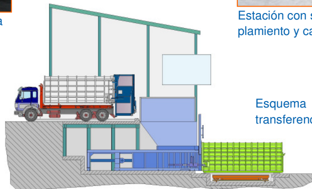
Estación de transferencia con tolva para descarga directa desde camión
