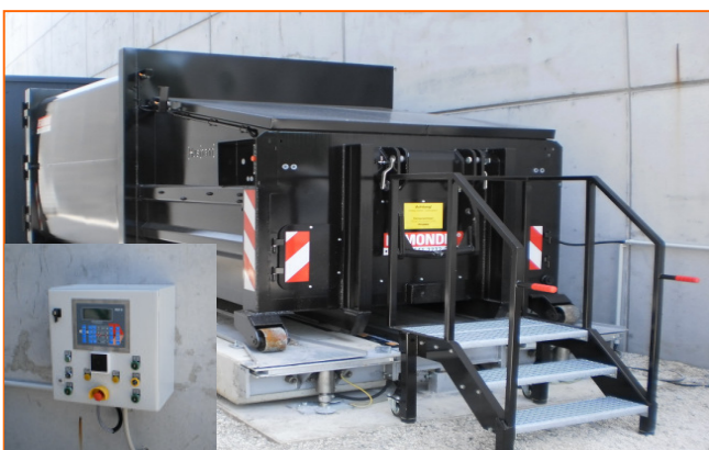
SPB con dispositivo de pesaje completo
