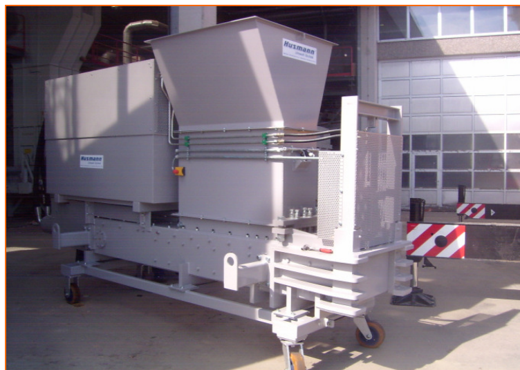
Compactador VK100 con cámara de precompactación
