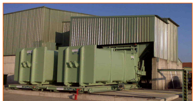
Compactador estático con carga mediante cinta transportadora y sistema automático de cambio de contenedores
