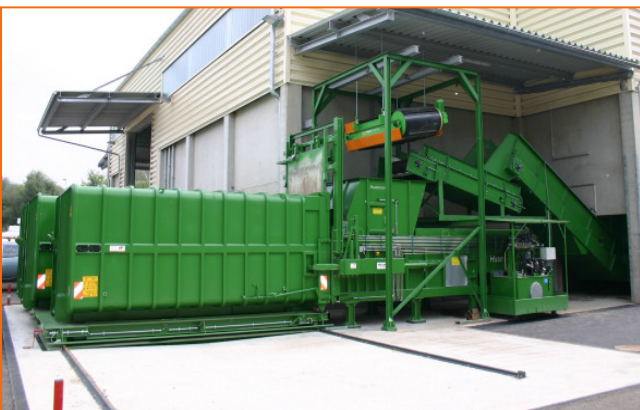
MP con sistema de cintas transportadoras y colector magnético de elementos féreos
