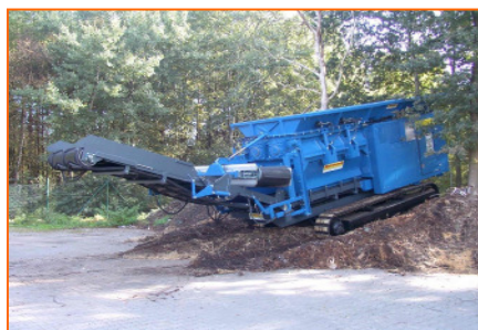
Trituradora autónoma HLII 1622 con sistema de oruga
