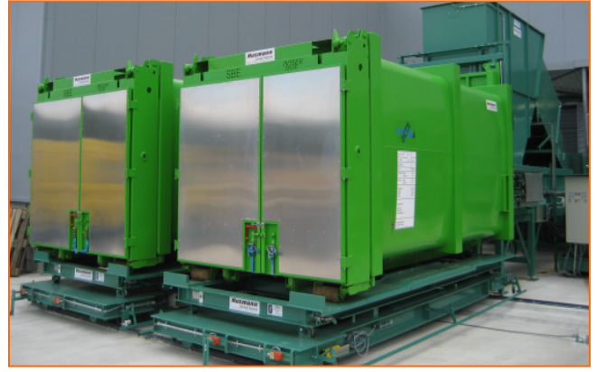
Dispositivo de cambio de contenedor automático para compactador estático
