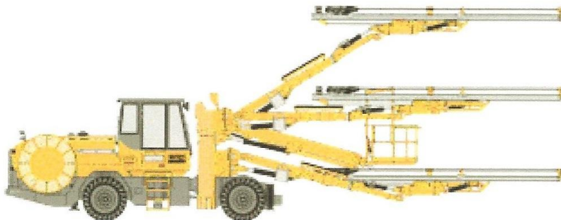
Ilustración 7 Jumbo para la perforación
