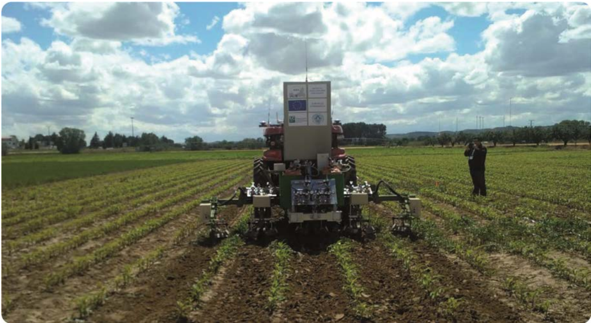
Figura 3. Implemento cultivador y con tratamiento térmico automatizado aplicando el tratamiento de control de malas hierbas sobre un campo de maíz
