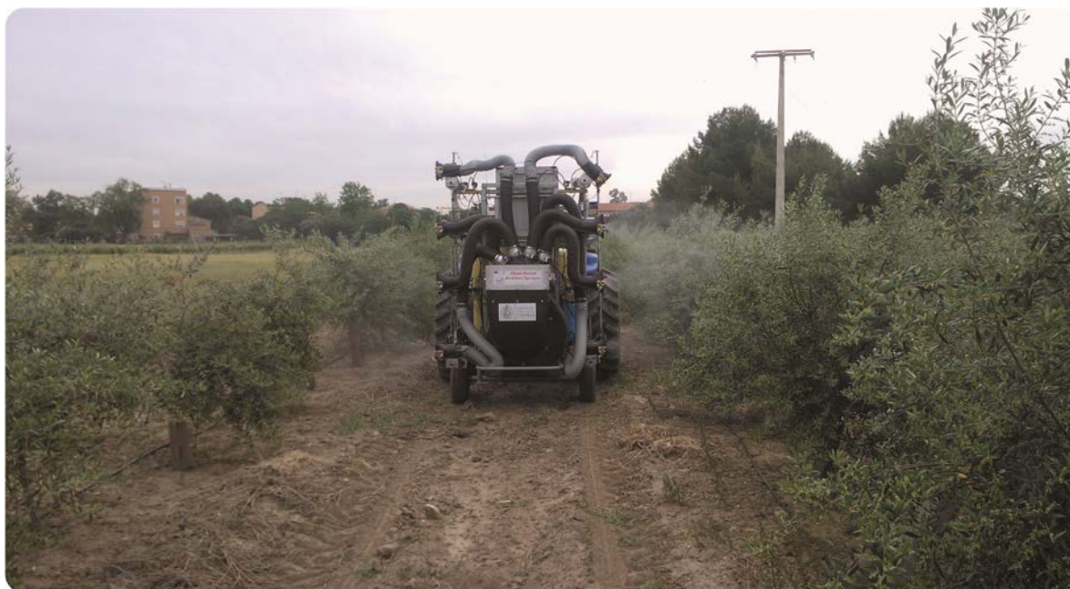
Figura 4. Implemento fumigador autónomo aplicando el tratamiento de control de plagas de insectos sobre un campo de olivos
