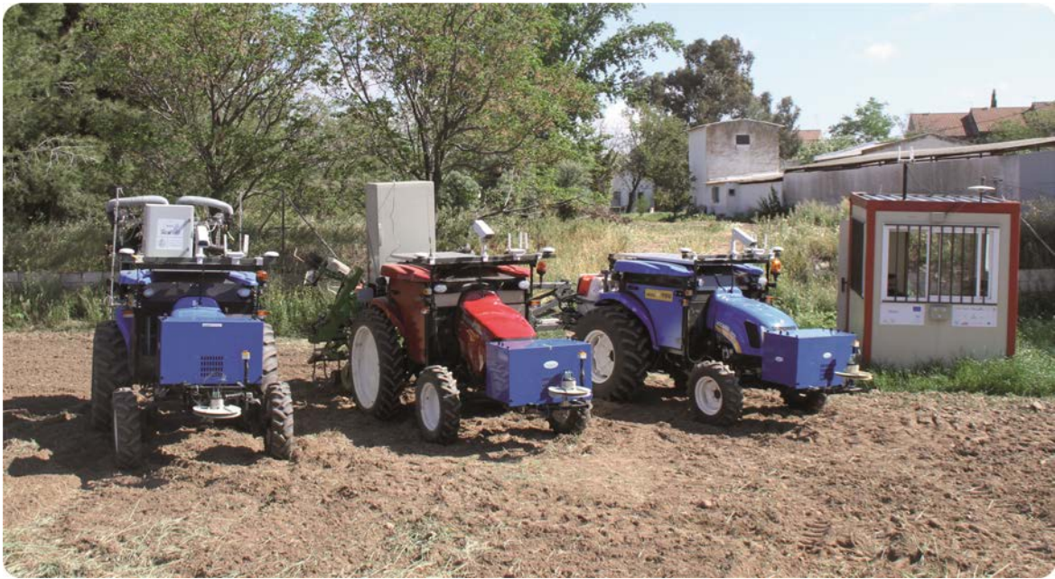
Figura 1. Flota de tractores robotizados y estación base
