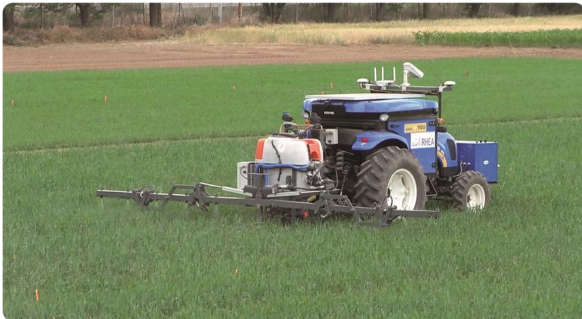
Figura 2. Implemento sulfatador automatizado aplicando el tratamiento de control de malas hierbas sobre un campo de trigo
