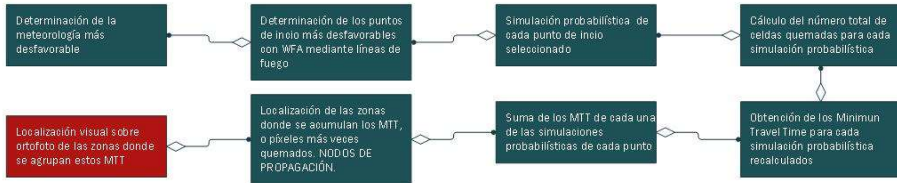
Ilustración 152 Proceso de obtención de los nodos de propagación con Wildfire Analyst. Fte. Elaboración propia.
