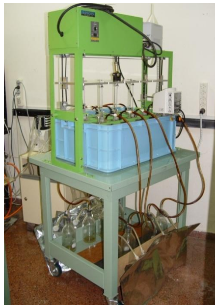
Figura 3.2 Sistema de 8 fermentadores de flujo semicontinuo (RUSITEC; Rumen Simulation Technique; Czerkawski y Breckenridge, 1977)
