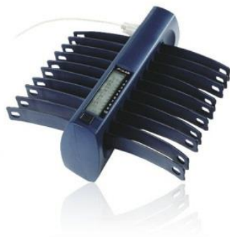
Figura 17. Interface Polar Team® mediante la cual se transferían los datos de frecuencia cardiaca registrados cada 5 segundos para su posterior análisis con el software Polar Pro Trainer 5.
