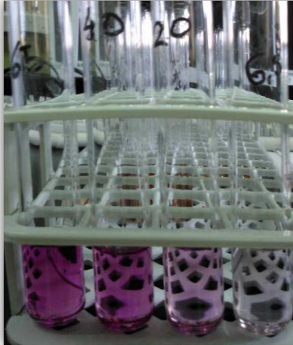
Figura 3.10. Fotografía tomada en el laboratorio tras la segunda incubación en el baño de agua a 100 °C. Rango de concentración de derecha a izquierda (6,5-65  $\mu\text{g}/\text{ml}$  de glucurónico). (Cedida por Diana Cuadrado Redondo).
