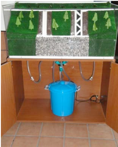
Fig. 3.11. Depósito del agua y grupo de bombeo.
