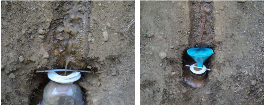
Fig. 3.16. Depósito adaptado para recogida de agua con sedimentos in situ y embudo de sedimentación.
