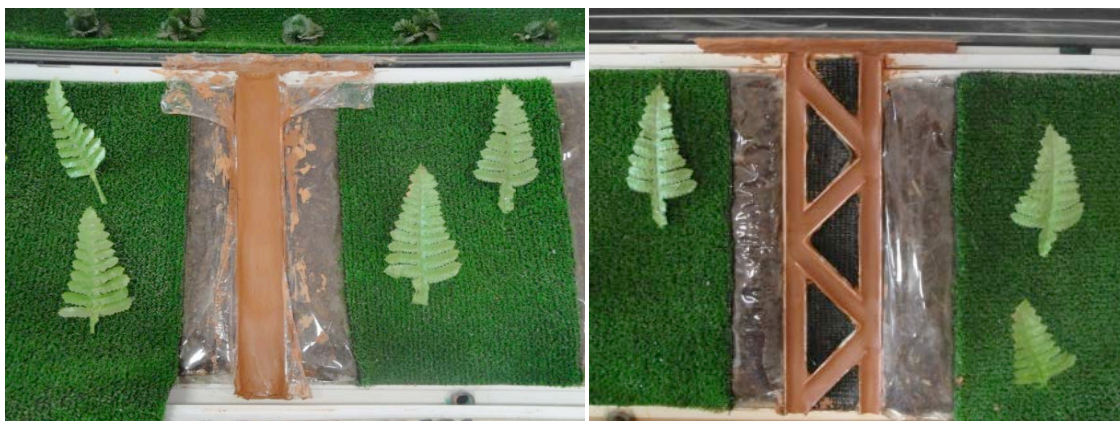
Fig. 3.14. Canal 1 (drenaje tradicional) y canal 2 (drenaje ramificado) moldeados en arcilla.
