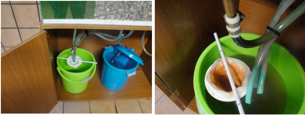
Fig. 3.15. Depósito de recogida de agua con sedimentos y embudo de sedimentación.
