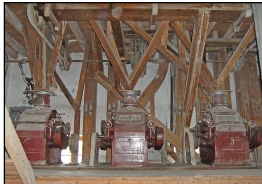
Figs. 137-138: Interior de los molinos de Villacelama (izda.) y Gradefes (dcha), con piedras y cilindros respectivamente. Fotografías: Yolanda García González y Javier Revilla Casado (autor).
