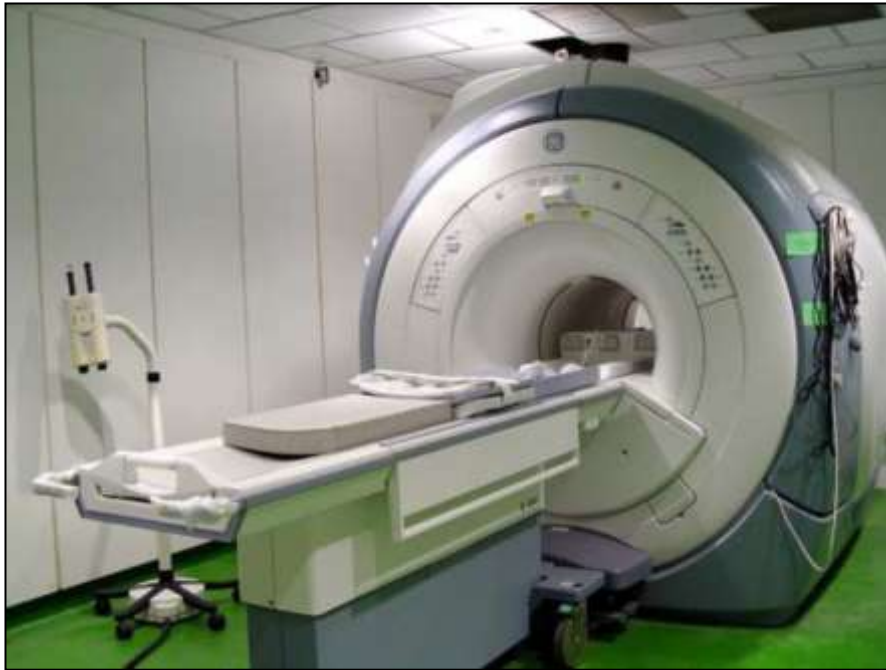
Figura 52: Equipo de IRM modelo SIGNA HDxt 3,0 T GE de la casa GENERAL ELECTRIC MEDICAL SYSTEM, con un imán superconductor de 3T.
