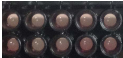
Figura 88. Resultado colorimétrico obtenido al analizar la concentración de elastina en los andamiajes de fibrina de la primera generación mediante el kit Fastin.
