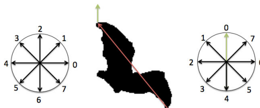
Figura 18: Ejemplo de construcción de la cadena de orientaciones del borde (BOC) invariante a la rotación. La flecha roja representa la distancia entre los puntos más alejados del contorno. La verde es la orientación del primer punto de la cadena. Los valores se asignan a cada orientación secuencialmente empezando por la flecha verde, la cual colocamos en la parte alta del diagrama como punto de origen (valor 0).
