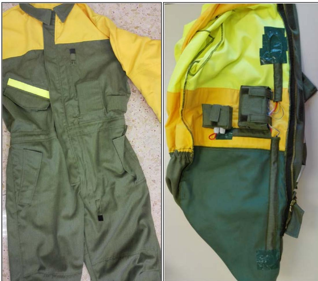
Figura 6.1. Izquierda vista general de los sensores exteriores. Derecha colocación de los sensores interiores y de los registradores de datos.
