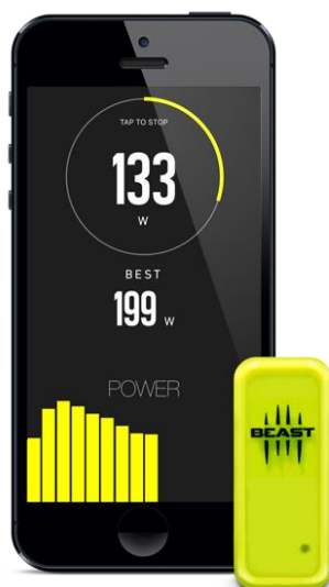
Figura 5. Dispositivo Beast Sensor e interfaz de la aplicación para smartphone
