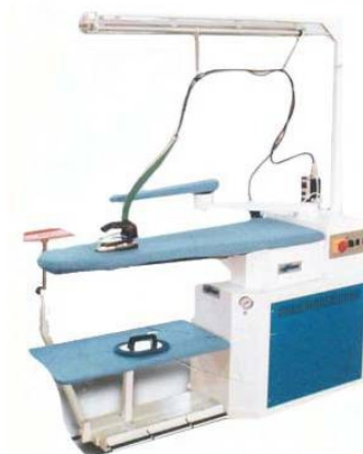
Figura 3.12 – Vaporeta aspirante e suflante, com ferro a vapor com caldeira.
