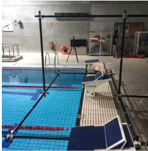
Figura 13. Tubos ensamblados formando el sistema de referencia empleado para la calibración de las cámaras.
