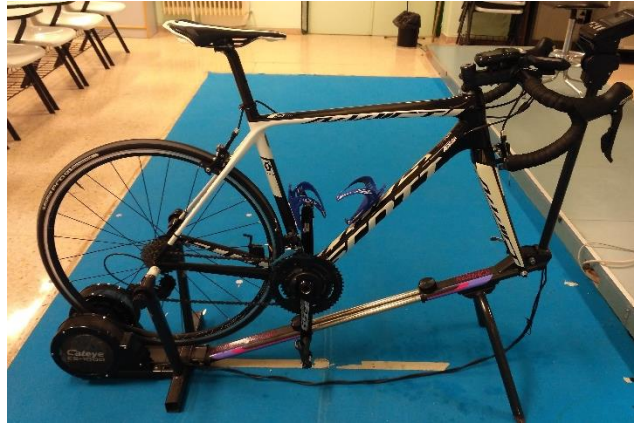
Figura 13. Ilustración con la bicicleta instalada sobre el rodillo fijo sobre el que se realizó el protocolo de pruebas de pedaleo
