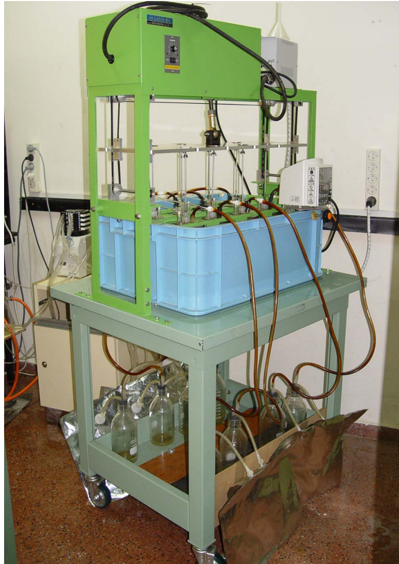
Figura 3.1. Sistema de fermentadores de flujo semicontinuo (Rusitec; Rumen Simulation Technique; Czerkawski and Breckenridge, 1977)
