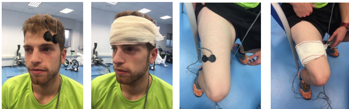
Figura 2. Colocación de los óptodos de la espectroscopia de infrarrojo cercano en cabeza y muslo
