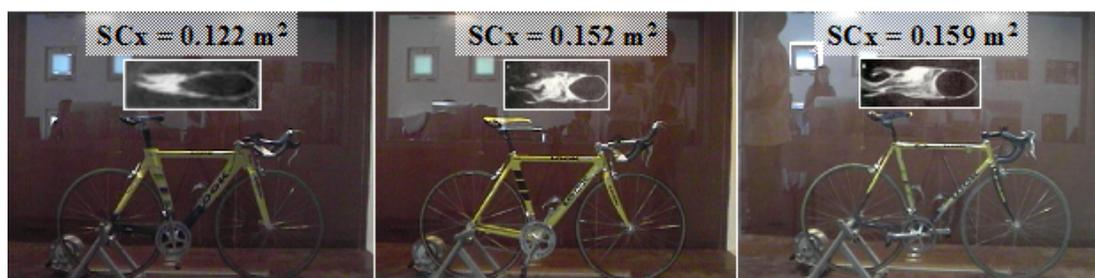
Figura-46.-Aerodinámica ( $S \cdot C_x$ ) de diferentes bicicletas: cuadro y manillar aerodinámico ( $0.122 \text{ m}^2$ ), cuadro triangular y manillar aerodinámico ( $0.152 \text{ m}^2$ ), cuadro y manillar convencionales ( $0.159 \text{ m}^2$ ).
